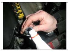
3. Injektorreiniger einfüllen (ca. 50 – 100 ml).
