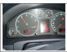
Weiter die Motordrehzahl bei 3000 U/Min. für 20 Sekunden halten.
