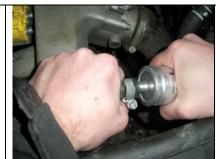
2. Gasschlauch am Filterende zu den Injektoren lösen.
